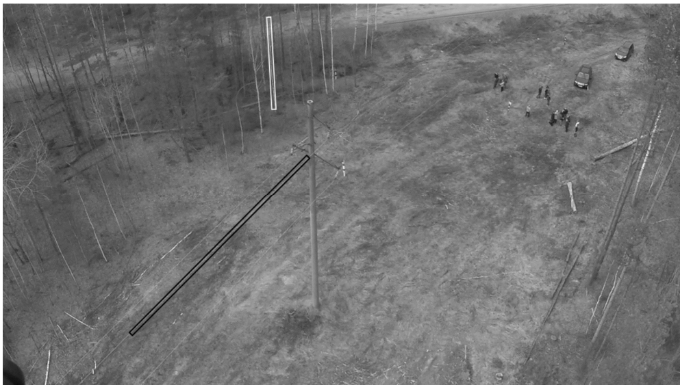
Рис. 3. Случайный кадр видеопоследовательности, взятый для оценки отношения сигнал/шум, с отмеченными на нём фрагментами, соответствующими изображению провода (чёрная рамка) и ствола дерева (белая рамка)
